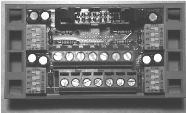
XAF est l'interface de câblage correspondante pour les entrées/sorties analogiques et les entrées d'impulsions sur le module XIO. Le module comprend des commutateurs de configuration permettant de personnaliser le module en fonction de l'utilisation. Ces commutateurs permettent le filtrage (lors de l'utilisation d'une cellule de charge), de travailler avec un codeur optique (mode direct) ou d'afficher le courant (4-20mA). Un raccordement un câble plat est utilisé pour une installation simple.
