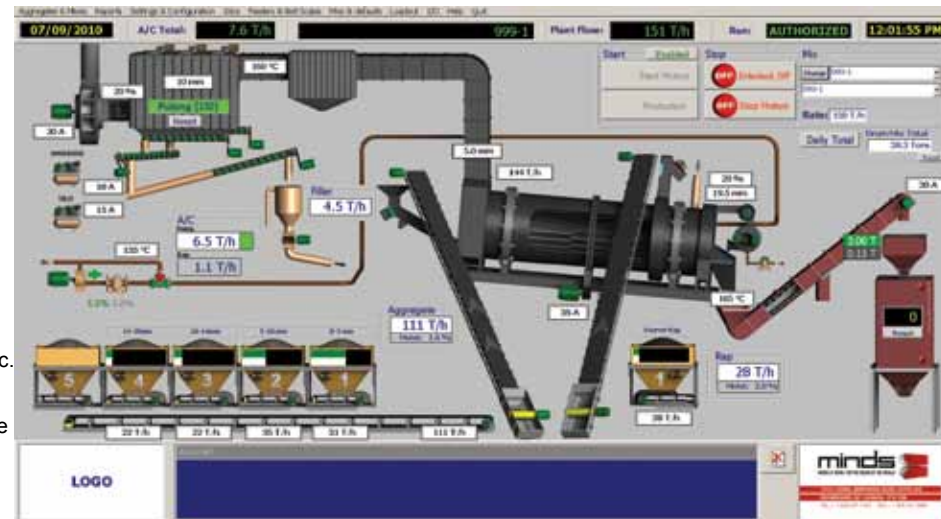
Le système DrumTronic permet aux opérateurs de l'usine d'avoir un à quatre écrans qui affichent des graphiques à barres, des configurations de l'usine, des diagrammes et autres pour donner un aperçu rapide et facile de l'état de l'usine.
